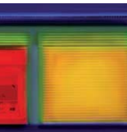
Tento záznam tepla obvyklých rolovacích vrat jasně ukazuje velké tepelné ztráty směrem ven.
