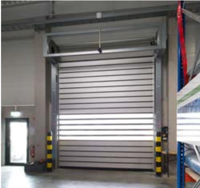
Die Undurchlässigkeit aller Tore wird durch verschleißarme vertikale Torblattdichtungen aus Kunststoff gewährleistet. Die Lamellen werden durch Gummilippen untereinander isoliert. Zwischen Sturz, Torblatt und den Zargen ist ein horizontales, klappbares Profil eingesetzt, das sich beim Schließen der Toranlage automatisch an das Torblatt andrückt und so einen Luftverbund von außen nach innen verhindert.
