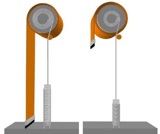
In den Seitenzargen sind Zugfedern installiert, die über Schwerlastgurte direkt mit der Antriebswelle verbunden sind. Die Federn sind in „Tor-zu-Position“ gespannt (Abb. links) und in „Tor-auf-Position“ (Abb. rechts) entspannt.
