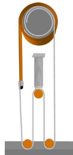
Das Windlastsystem von EFAFLEX sorgt für permanente Torblattspannung. Perfekt immer da, wo Wind oder Unterdruck Zugluft verursachen!
