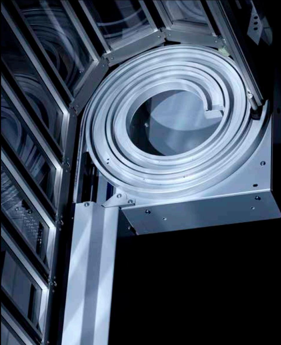
Vor über 25 Jahren hat EFAFLEX das Spiraltor erfunden und dieses als Innovationsführer seitdem kontinuierlich weiterentwickelt. Die EFAFLEX-Spirale steht für Torblattführung in Perfektion: Das Torblatt wird dabei nicht auf einer Welle aufgewickelt, sondern von der spiralförmigen Führung platzsparend auf Abstand gehalten. Durch dieses mechanische Prinzip laufen Spiraltore von EFAFLEX ausgesprochen leise, nahezu verschleißfrei und außerordentlich schnell.
