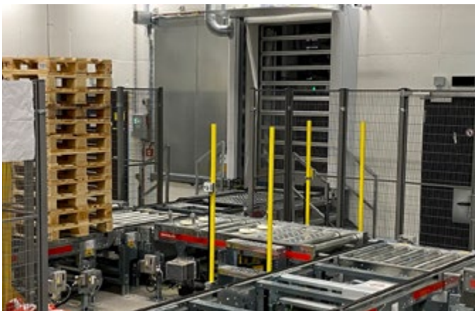
Paletten-Einfahrt zum Hochregallager mit EFA-STT. Version mit Klarsicht-Lamellen
